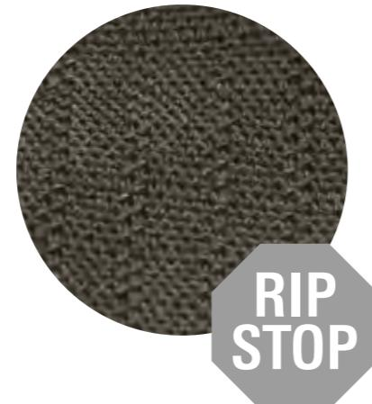
**Rip-Stop-Gewebe** haben es faustdick hinter der Bindung und sind absolut reißfest. Verantwortlich dafür: eine spezielle Webtechnik. Im Abstand von 5 bis 8 Millimetern werden dickere Fäden in das ansonsten dünneren Gewebe integriert. Das Ergebnis: die typische „Rechenkästchenstruktur“ mit Stabilitäts-Faktor.
